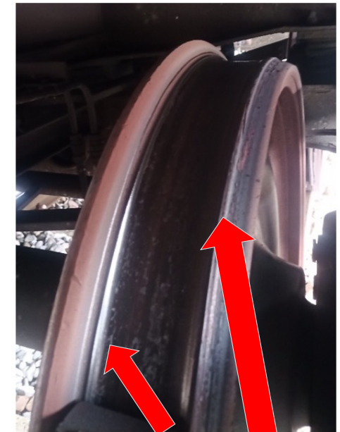
Außergewöhnliche Laufflächenveränderung an der Außenseite der Radoberfläche und am Spurkranz
