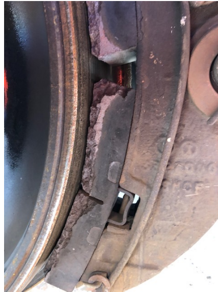
Farbveränderung und ausgebrochenes Material
