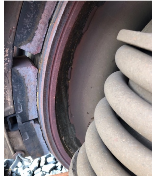
Farbveränderungen an der Sohle und verbrannte Farbe an der Radscheibe
