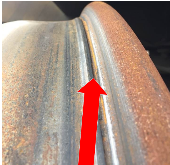
Außergewöhnliche Laufflächenveränderung an dem Spurkranz
