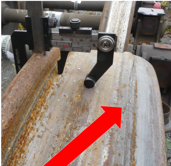
Außergewöhnliche Laufflächenveränderung an der Außenseite der Radoberfläche
