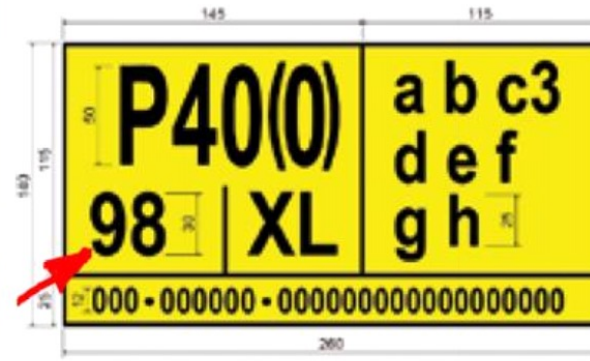
Bild 5.1: Beispiel: Sattelaufleger, der eine Stützbockhöhe von 98 cm benötigt
