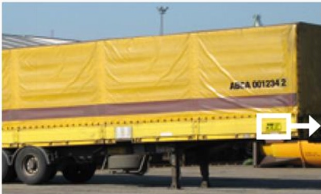
Bild 5.1: Beispiel: Sattelaufleger, der eine Stützbockhöhe von 98 cm benötigt
