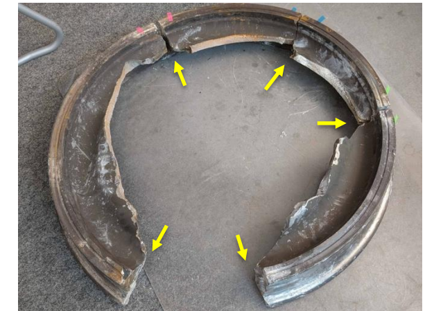
Radbruch durch thermisch induzierte Ermüdung, Quelle: W.S.
