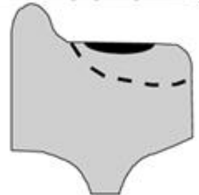
Thermisch induzierter Riss aus der amerikanischen Literatur, Quelle: DOT-VNTSC-FRA-02-02
