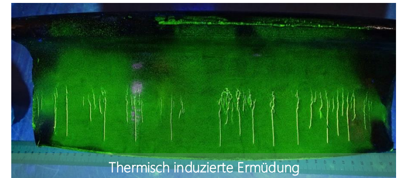
Fluoreszierende Magnetpulverprüfung einer Lauffläche, Quelle: W.S.
