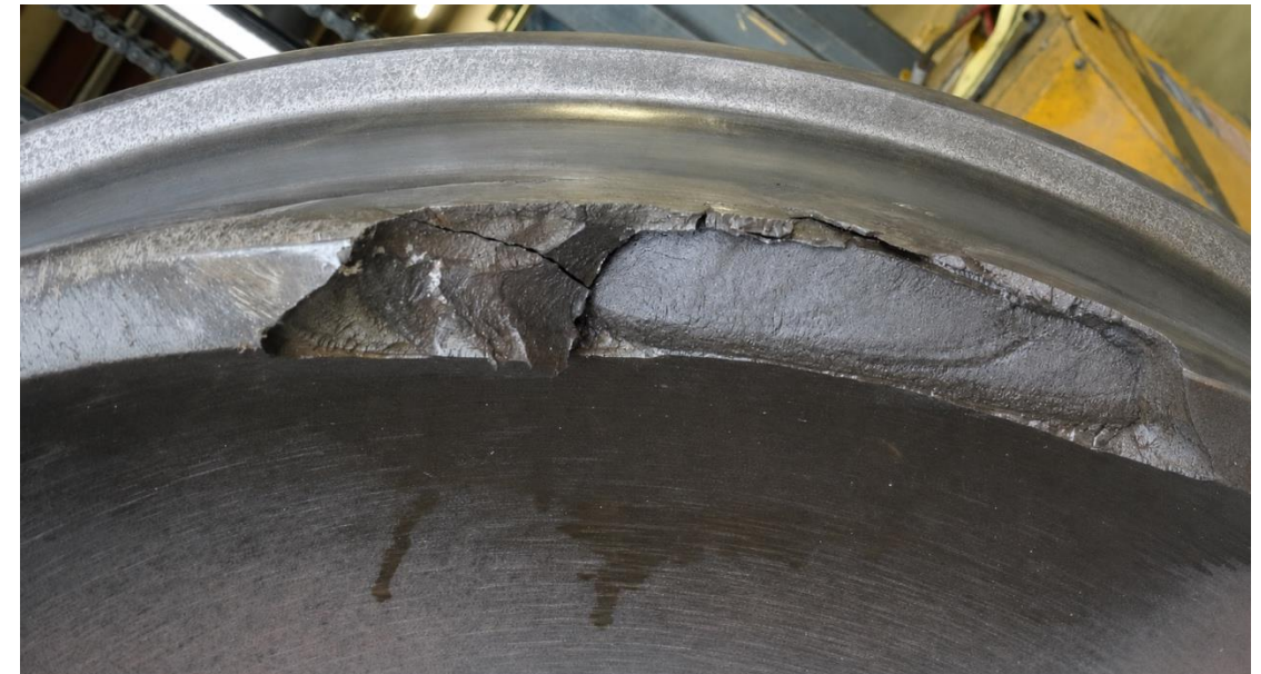
Vertikaler Ermüdungsriss im Radkranz eines Eisenbahnrades. Quelle: DOT/FRA/ORD-21/36
