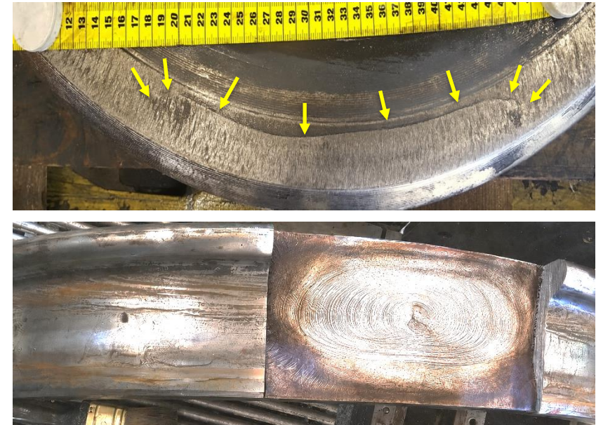
Ermüdungsriss unter der Lauffläche (ca. 10 mm) eines Eisenbahnrades. Quelle: W.S.
