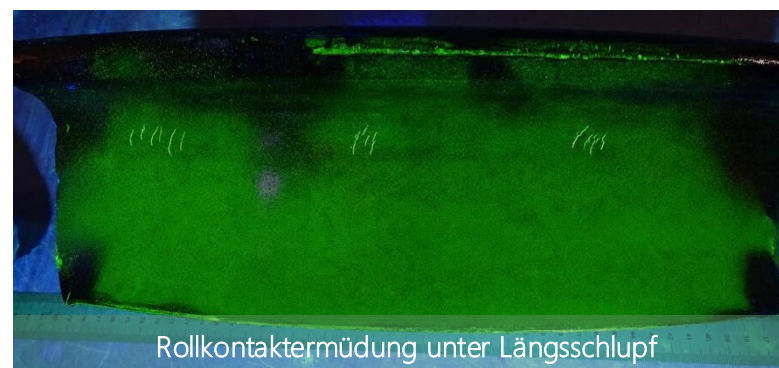
Rollkontaktermüdung unter Längs- und Querschleppf
